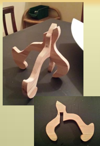
Aragn: due parti in legno massello che si accoppiano a formare un supporto da tavolo
